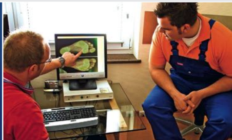
digitale Vermessung des Fußprofils | mesure digitale du profil des pieds | digital measurement of the feet profile
